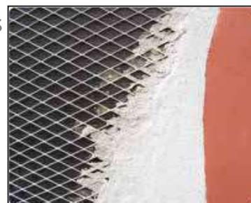
Esta es una malla metálica de una sola pieza, es formada a partir de una lámina de acero al carbón, sin uniones ni soldaduras lo que la hace muy resistente y de fácil instalación. Ampliamente utilizado en arquitectura e ingeniería.
